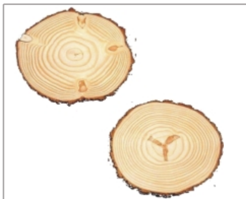
Figura 14 -Efeito da desrama na produção de madeira sem nó. A imagem do alto é de uma tora que não foi corretamente desramada. Abaixo, tora sem nós, a árvore foi desramada corretamente e a madeira tem maior valor comercial.
