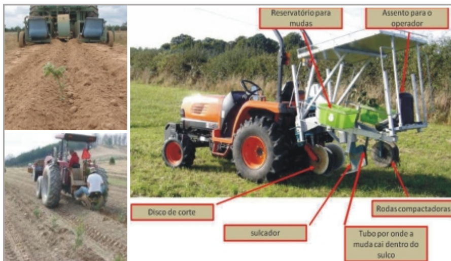
Figura 12 – Acima, máquinas de plantio florestal em operação; abaixo, modelo do conceito da máquina de plantio florestal tracionada por trator. (Fonte: Imagens recolhidas da internet: termo buscador “tree planting machine”)
